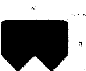
กระเบื้องพื้นหลังคา (Main Tile) กว้าง x ยาว x มล: 60 x 44 x 0.6 น้ำหนัก 2.5 กก./แผ่น จำนวนใช้รบน 11.11 แผ่น/ตร.ม.
